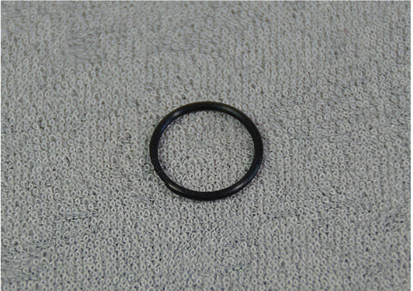
Überprüfen Sie den O-Ring zur Sicherung der Federeinheit und den O-Ring zur Sicherung der Aufbaueinstellschraube. Tauschen Sie die O-Ringe gegen neue aus, wenn sie verschlissen sind.
