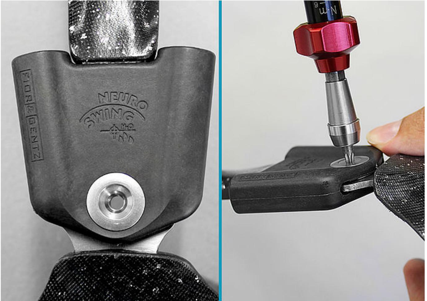
Demontieren Sie das Systemgelenk vollständig. Reinigen Sie alle Bauteile und untersuchen Sie diese dann eingehend.
