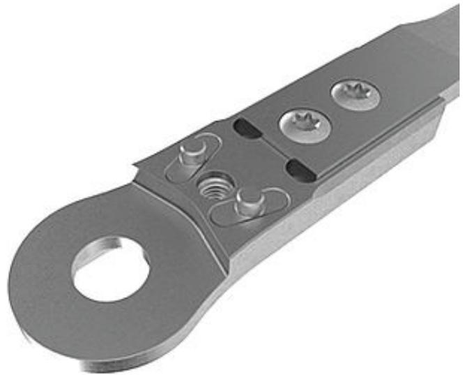
Entfernen Sie den Montage-/ Gießdummy. Verpressen Sie das Gelenkoberteil und die Passfedern mit Stift behutsam in einem Schraubstock mit glatten Backen, bis die Passfedern mit Stift bündig mit dem Gelenkoberteil abschließen.
