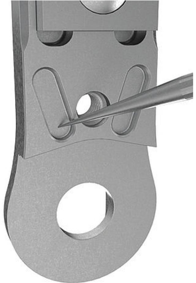
Reinigen Sie die Nuten am Gelenkoberteil gründlich, da sonst die Passfedern mit Stift nicht richtig montiert werden können. Dies ist wichtig, da sich falsch montierte Passfedern mit Stift nur sehr schwer wieder entfernen lassen.
