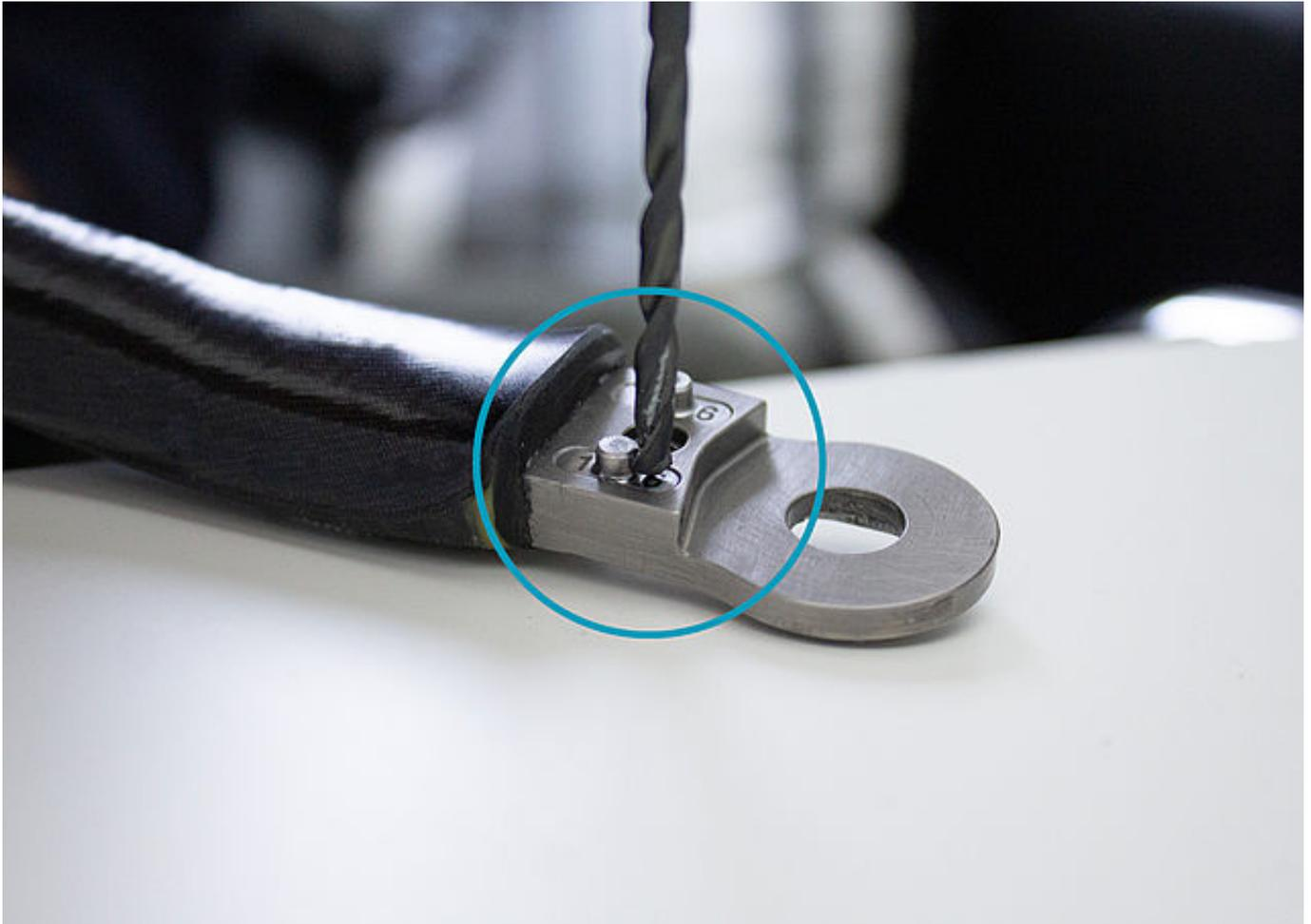
Entfernen Sie defekte Passfedern mit Stift, indem Sie sie vorsichtig mit einem kleinen Bohrer ausbohren.
