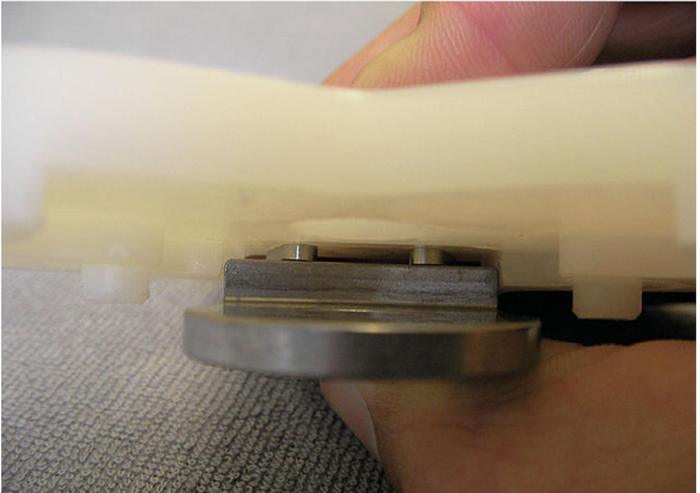
Setzen Sie den Montage-/Gießdummy so auf das Gelenkoberteil, dass die Passfedern mit Stift in den Nuten sitzen.
