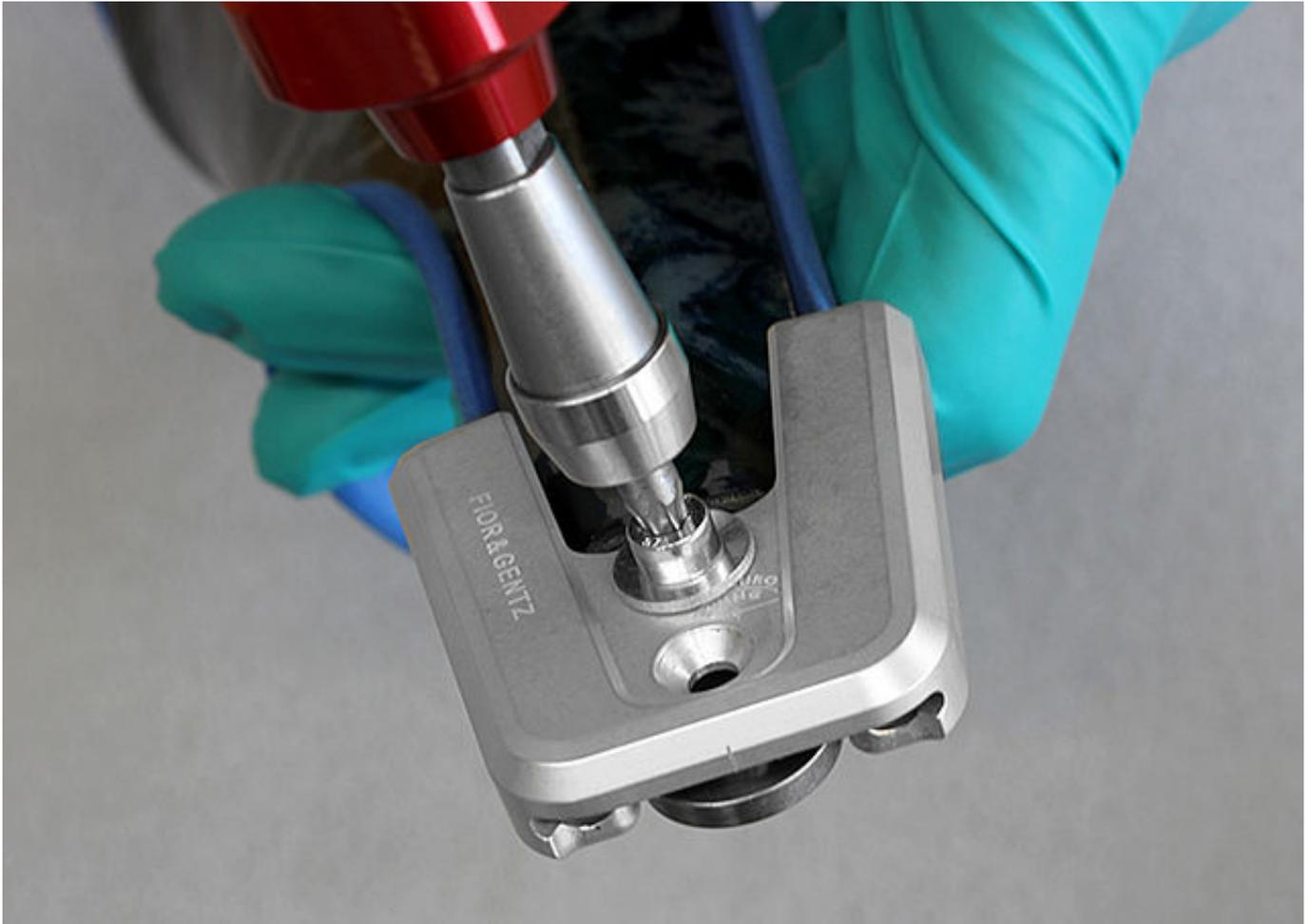
Montieren Sie die Deckplatte an das Gelenkoberteil, ohne die beiden zu verkleben. Verpressen Sie das Gelenkoberteil und die Deckplatte wie in der [Gebrauchsanweisung](#) beschrieben. Fahren Sie wie gewohnt mit der Gelenkmontage fort.
