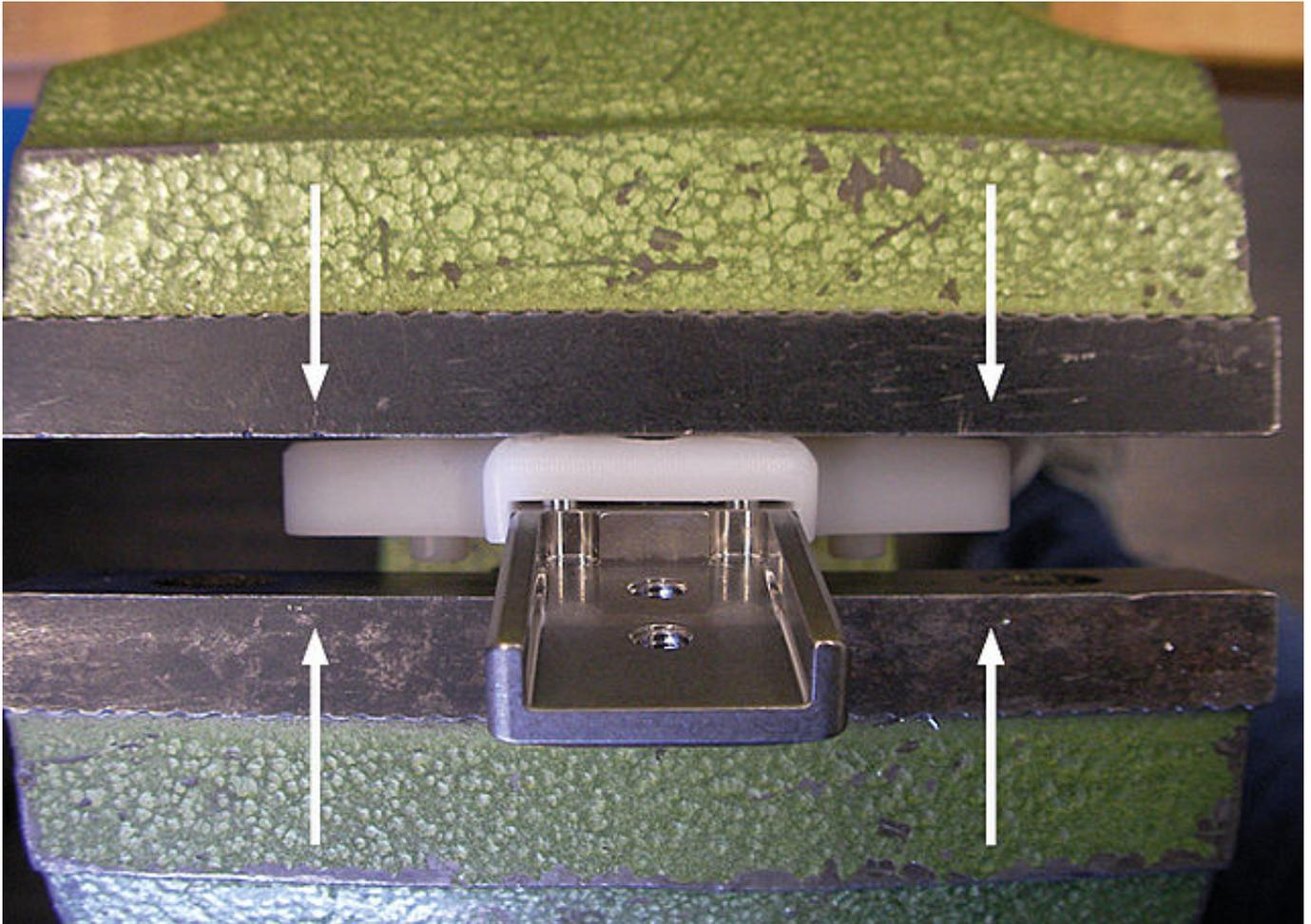
Verpressen Sie den Montage-/Gießdummy und das Gelenkoberteil in einem Schraubstock mit glatten Backen, bis zwischen beiden kein Spalt mehr zu sehen ist.
