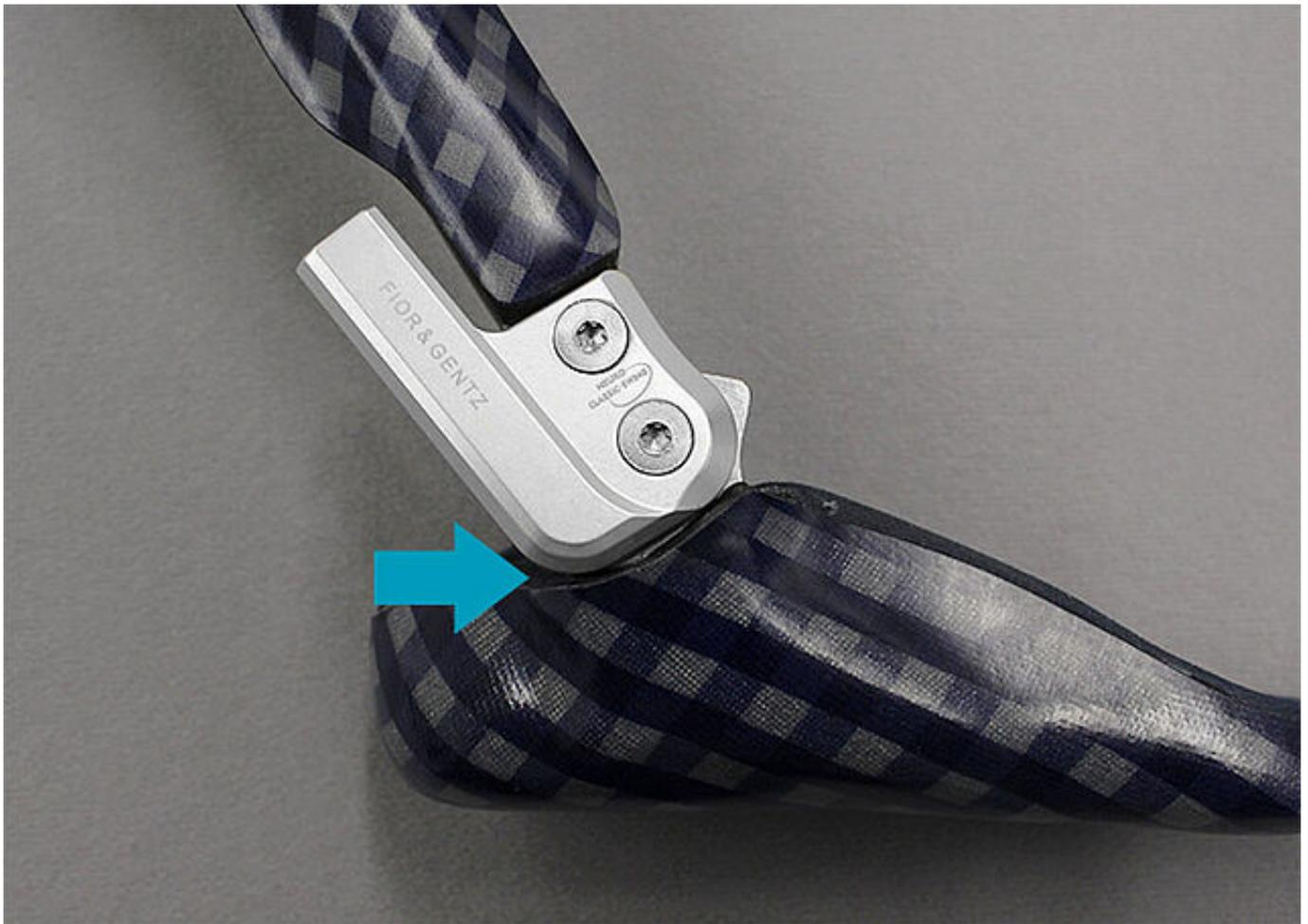
Bringen Sie das Systemgelenk in Plantarflexion und überprüfen Sie den Sitz der Deckplatte am Laminat. Nehmen Sie bei Bedarf Anpassungen am Laminat vor.
