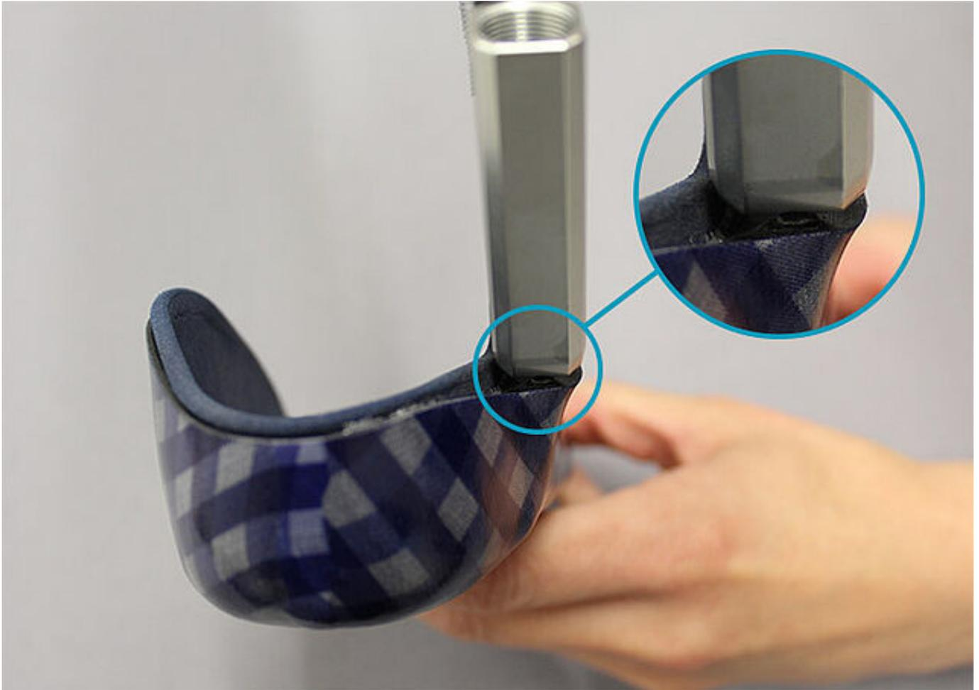
Überprüfen Sie den Sitz der Deckplatte auch von hinten und nehmen Sie bei Bedarf Anpassungen am Laminat vor.
