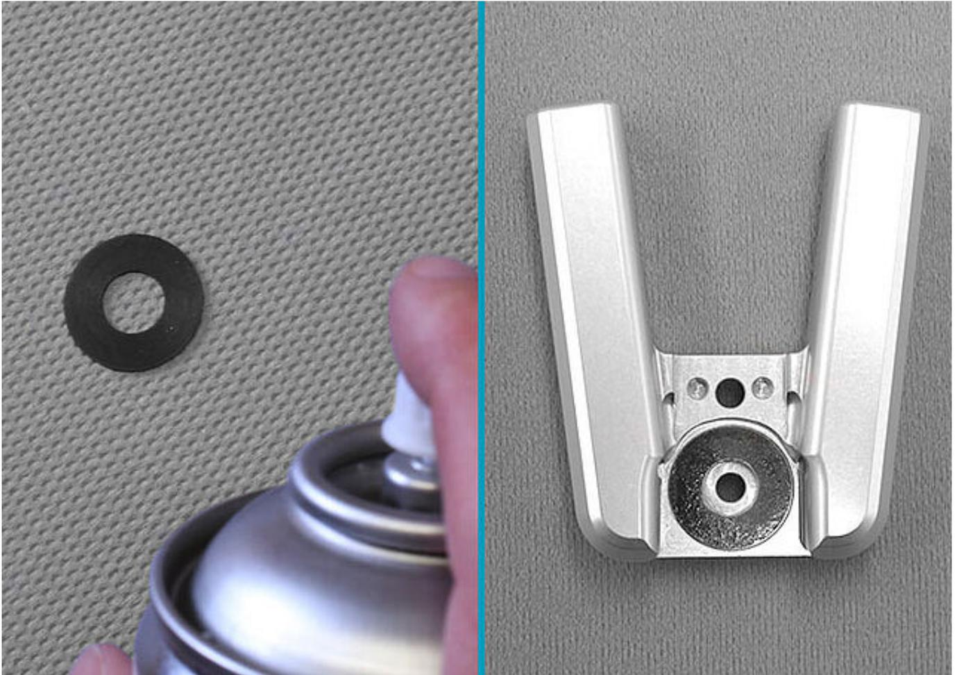
Besprühen Sie die erste Gleitscheibe auf einer Seite mit Sprühkleber und kleben Sie sie in die Deckplatte. Fetten Sie die andere Seite der Gleitscheibe leicht mit Orthesengelenkfett.
