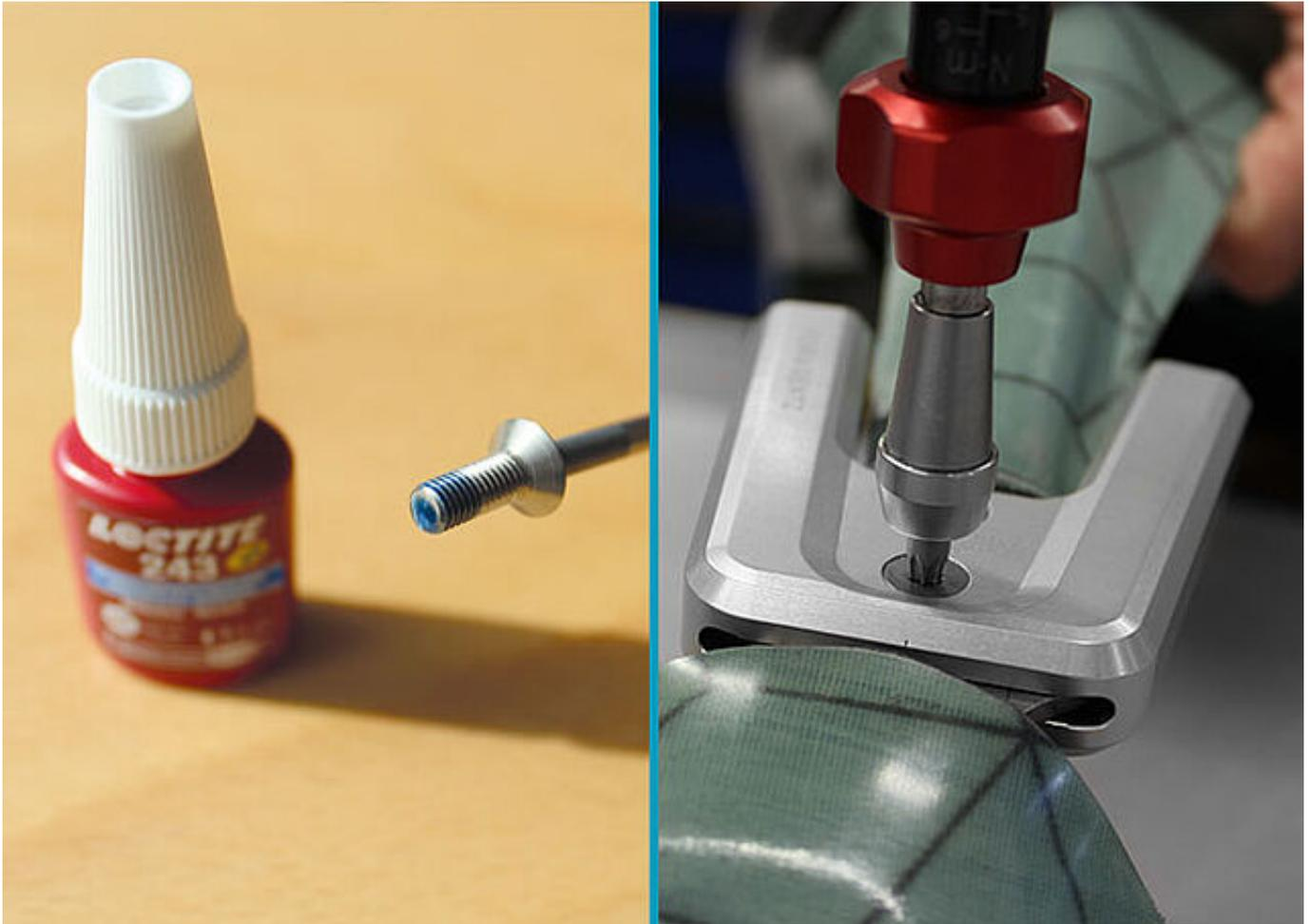
Sichern Sie beide Schrauben mit LOCTITE® 243 mittelfest und dem der Systembreite entsprechenden Drehmoment. Lassen Sie den Kleber aushärten (nach ca. 24 Stunden endfest). Setzen Sie vorhandene Anschlagdämpfer und O-Ring-Dämpfer und/oder Federeinheiten ein.
