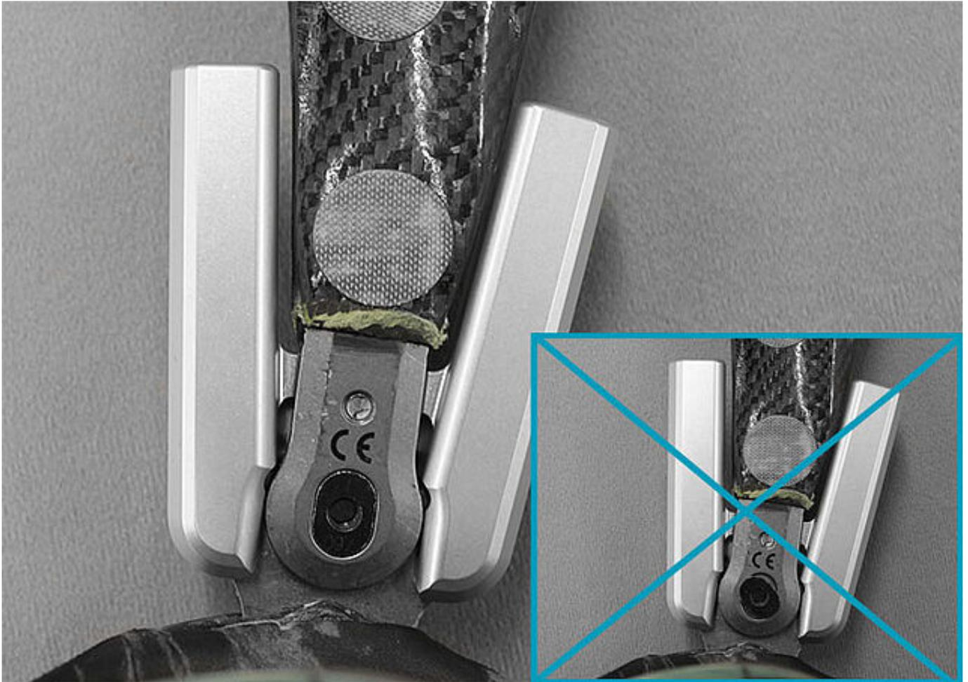
Setzen Sie den Splintbolzen in die dafür vorgesehene Öffnung am Gelenkoberteil ein und stellen Sie sicher, dass dieser richtig positioniert ist. Fixieren Sie ihn mit einem Finger.
