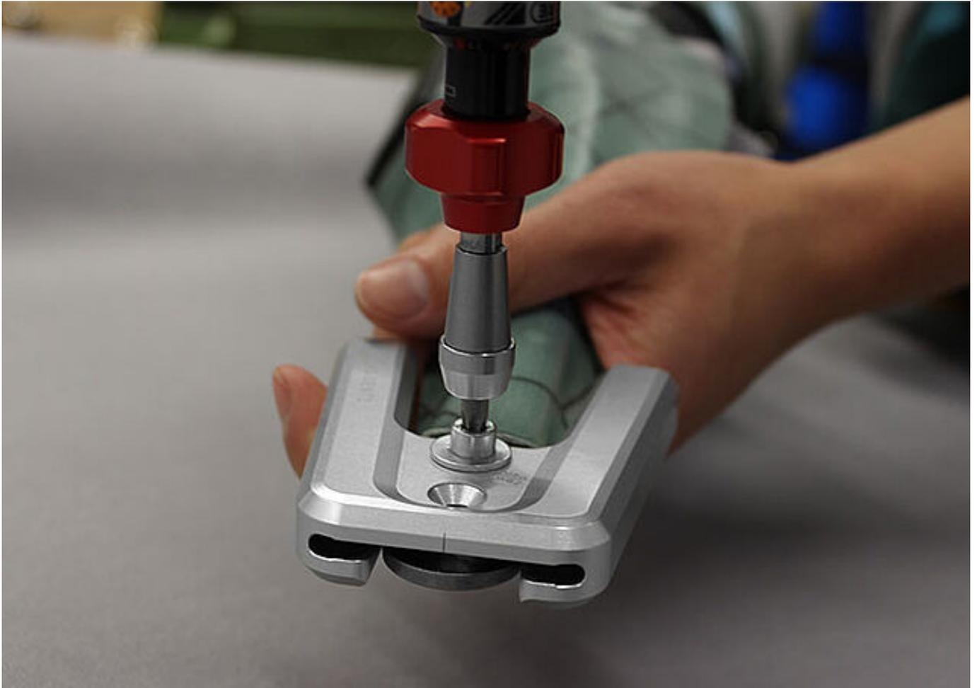
Verwenden Sie die mitgelieferte Deckplattenverpresshilfe, um die Deckplatte mit dem Gelenkoberteil zu verpressen. Ziehen Sie die Pressschraube mit dem entsprechenden Drehmoment fest.
