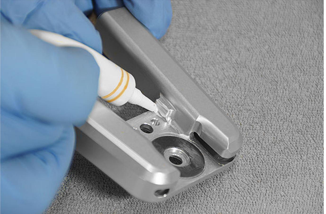
Fetten sie die Kontaktflächen zwischen Deckplatte und Gelenkoberteil mit Orthesengelenkfett, um mechanischen Geräuschen vorzubeugen.
