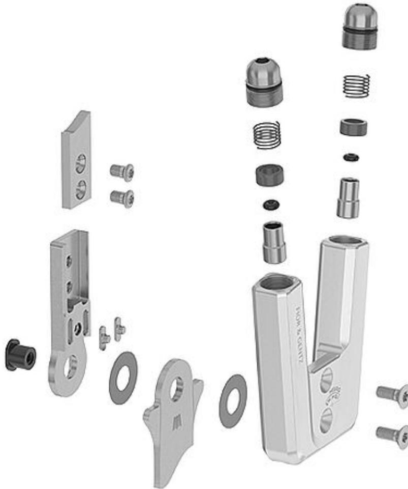
Säubern Sie das Systemgelenk. Reinigen Sie den Splintbolzen, das Gewinde des Gelenkoberteils sowie die Bohrungen der Deckplatte bei Bedarf mit LOCTITE® 7063 Schnellreiniger.
