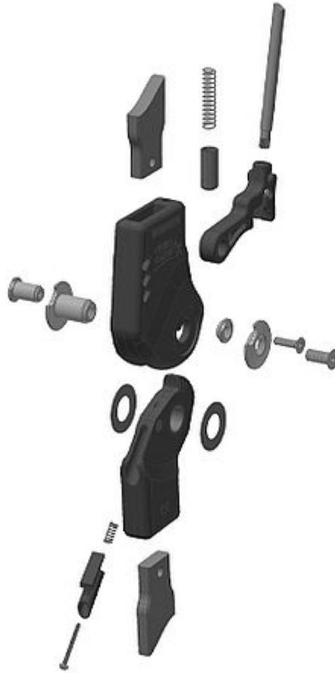
Reinigen Sie das Systemgelenk und alle Schraubengewinde (z. B. mit LOCTITE® 7063 Schnellreiniger), damit die Schrauben später effektiv gesichert werden können.
