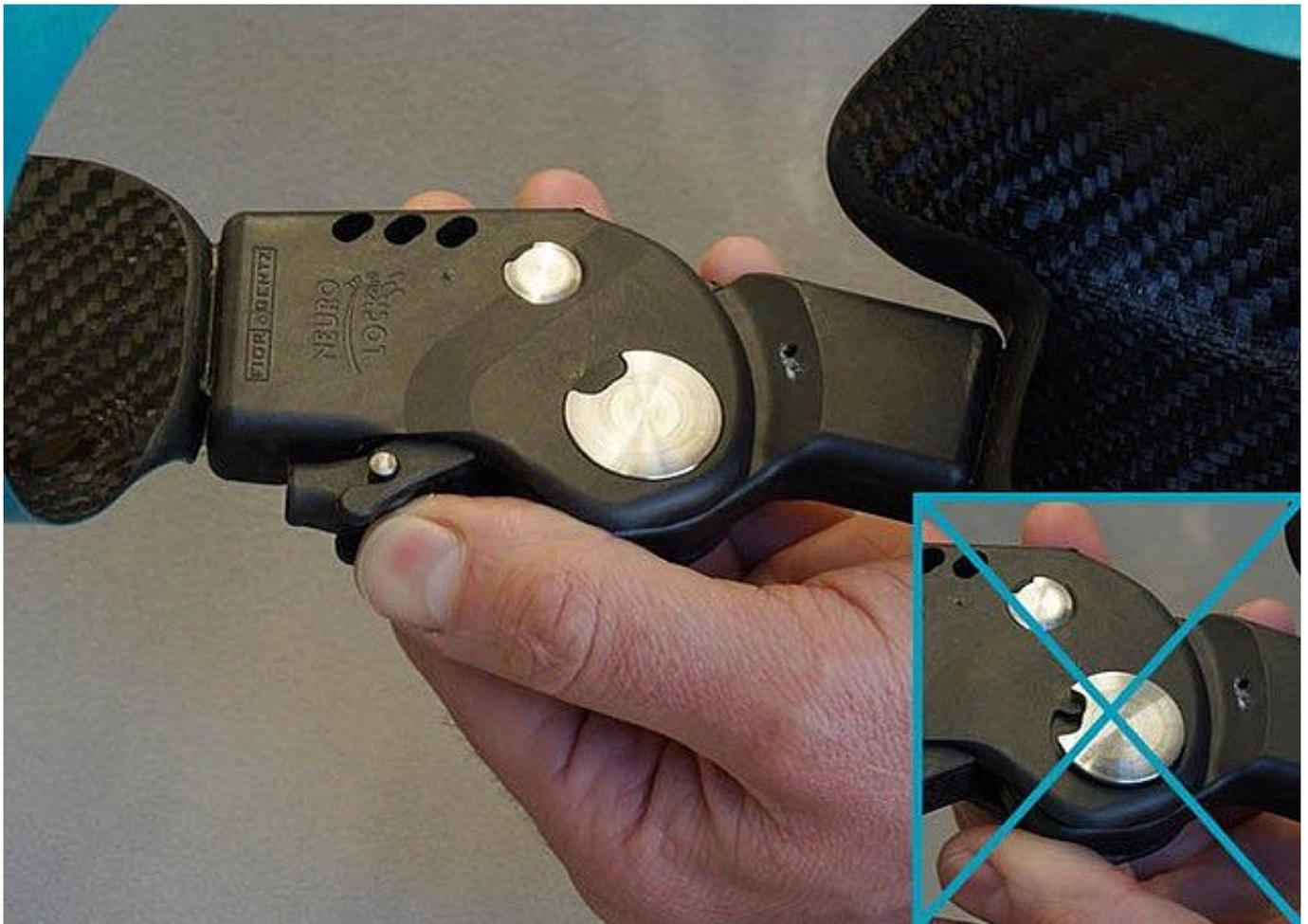
Setzen Sie den Splintbolzen in die dafür vorgesehene Öffnung an der Rückseite des Systemgelenkes ein. Achten Sie darauf, dass er richtig sitzt.
