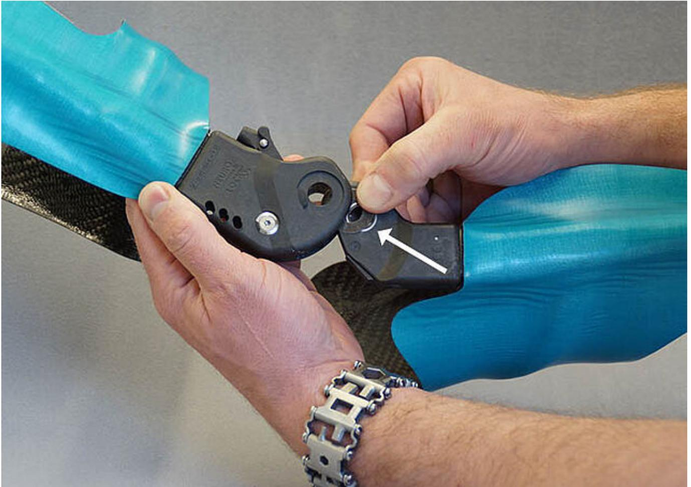
Platzieren Sie die gefetteten Gleitscheiben auf beiden Seiten des Gelenkunterteils. Schieben Sie das Gelenkunterteil von unten in das Gelenkoberteil.
