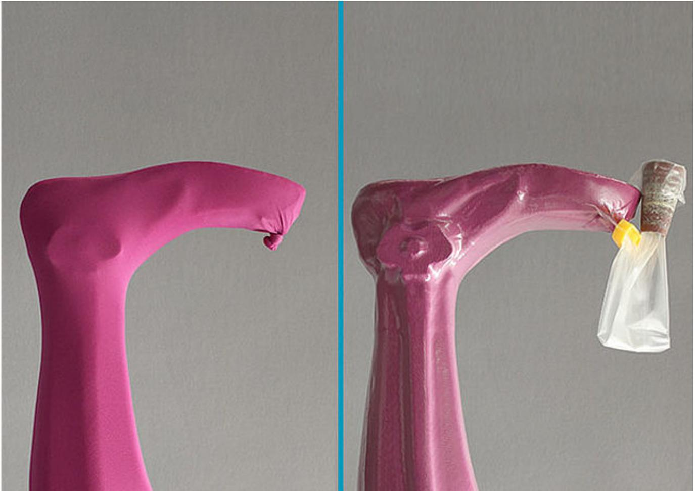
Ziehen Sie abschließend einen Dekostoff oder einen PA-Armierungsstrumpf (für Carbonoptik) über das Modell, um die Armierungslagen zu fixieren. So lässt sich der PVA-Folienschlauch als Oberfolie ganz einfach überziehen.
