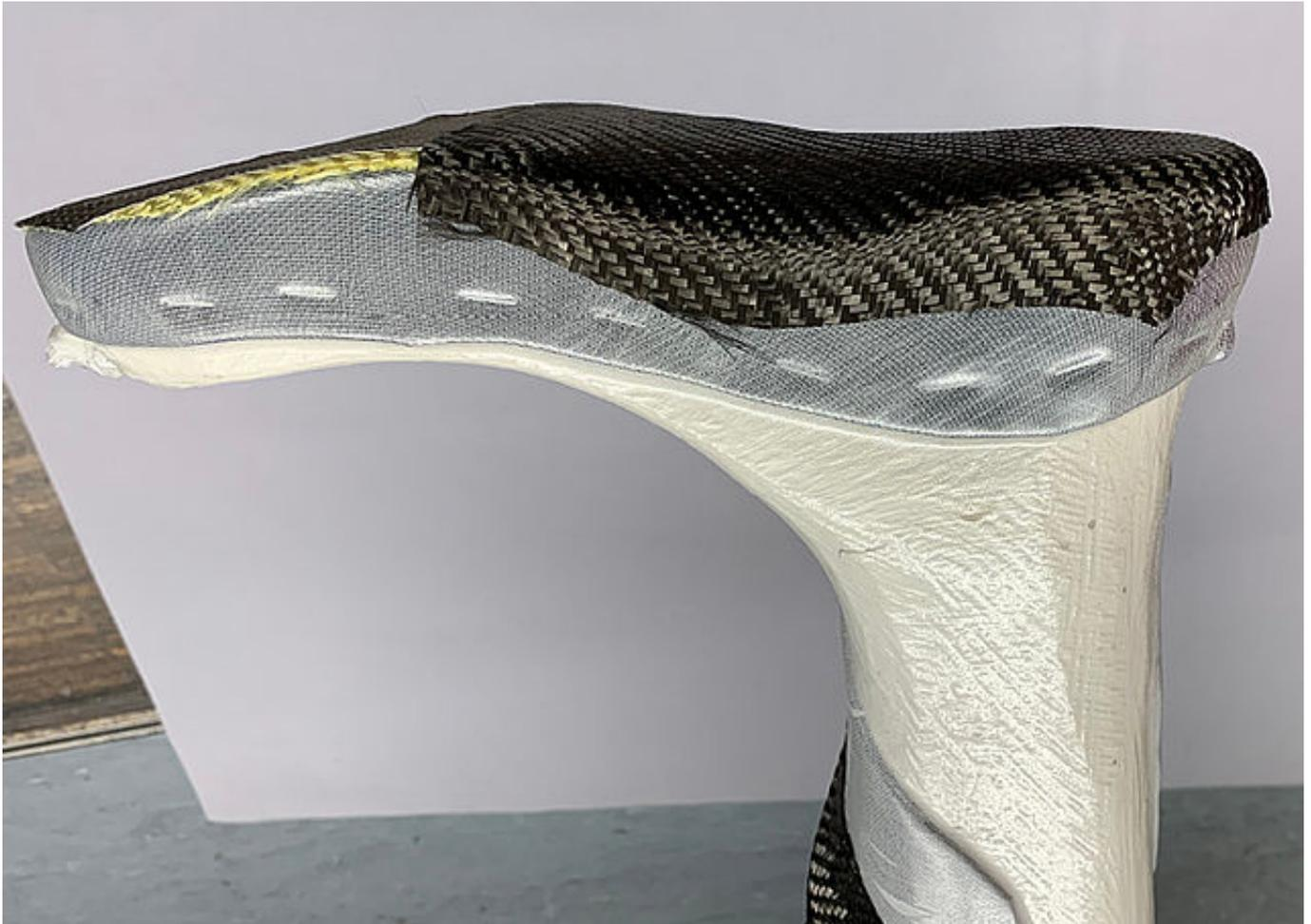
Positionieren Sie die Carbonfasergewebe-Zuschnitte bei unilateraler Bauweise an der medialen Seite nur entsprechend einer Brandsohle.
