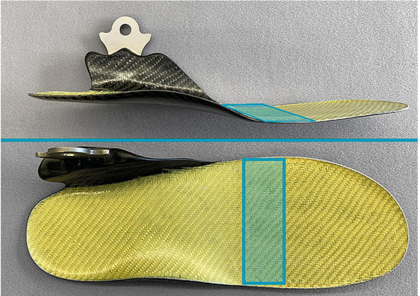
Armieren Sie den Vorfuß- und Abrollbereich (blauer Bereich) eines teilflexiblen Fußteiles **flexibel und ohne Rand**, um die Belastbarkeit und Lebensdauer des Materials zu erhöhen.
