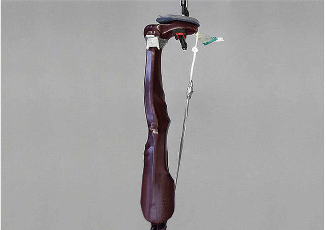
Lassen Sie das Modell über Nacht (mindestens 10 Stunden) unter Unterdruck bei Raumtemperatur stehen.
