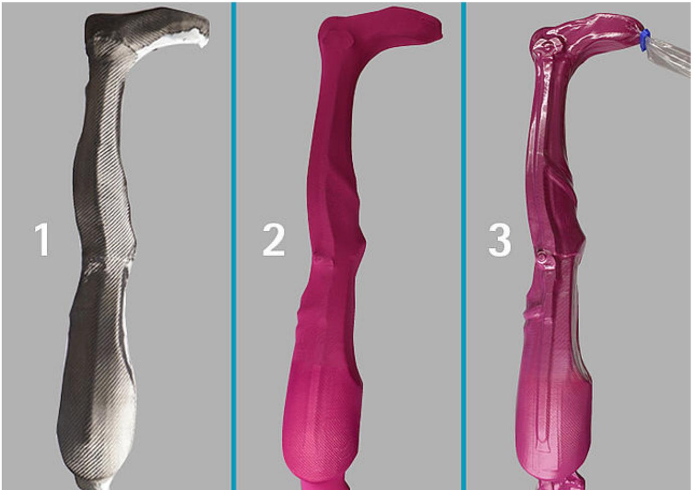
Ziehen Sie einen Dekostoff (2) oder einen PA-Armierungsstrumpf (für Carbonoptik) über das Modell (1), um die Armierungslagen zu fixieren. So lässt sich der PVA-Folienschlauch als Oberfolie (3) ganz einfach überziehen.
