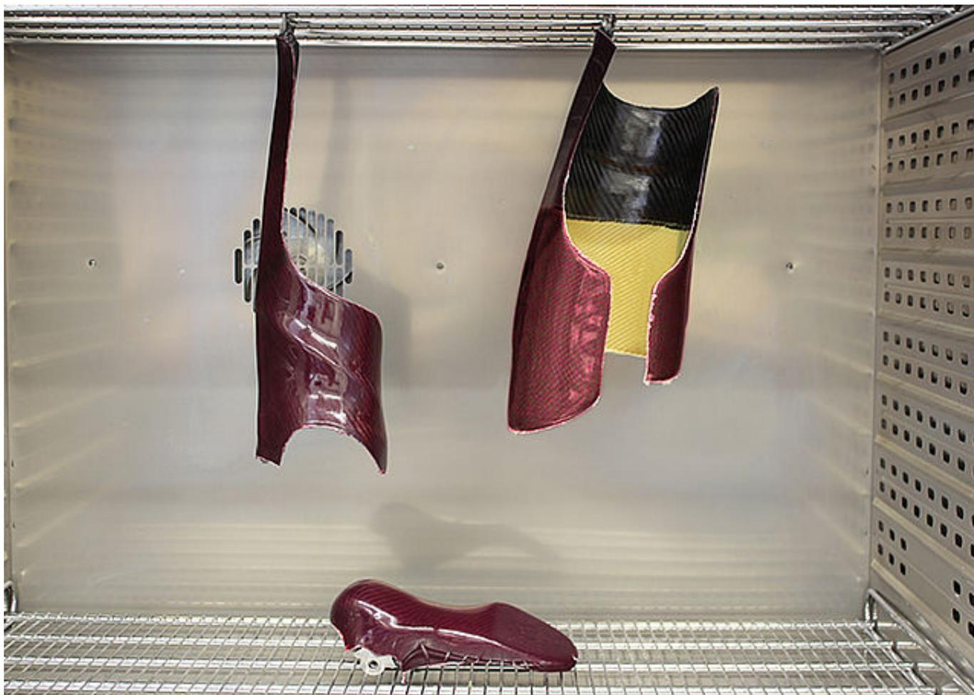
Tempern Sie die Orthesenteile, bevor Sie sie beschleifen. Legen Sie sie in den kalten Umluftofen und heizen Sie diesen langsam auf. Nach dem Tempern sind die Orthesenteile formstabil und lassen sich optimal bearbeiten.
