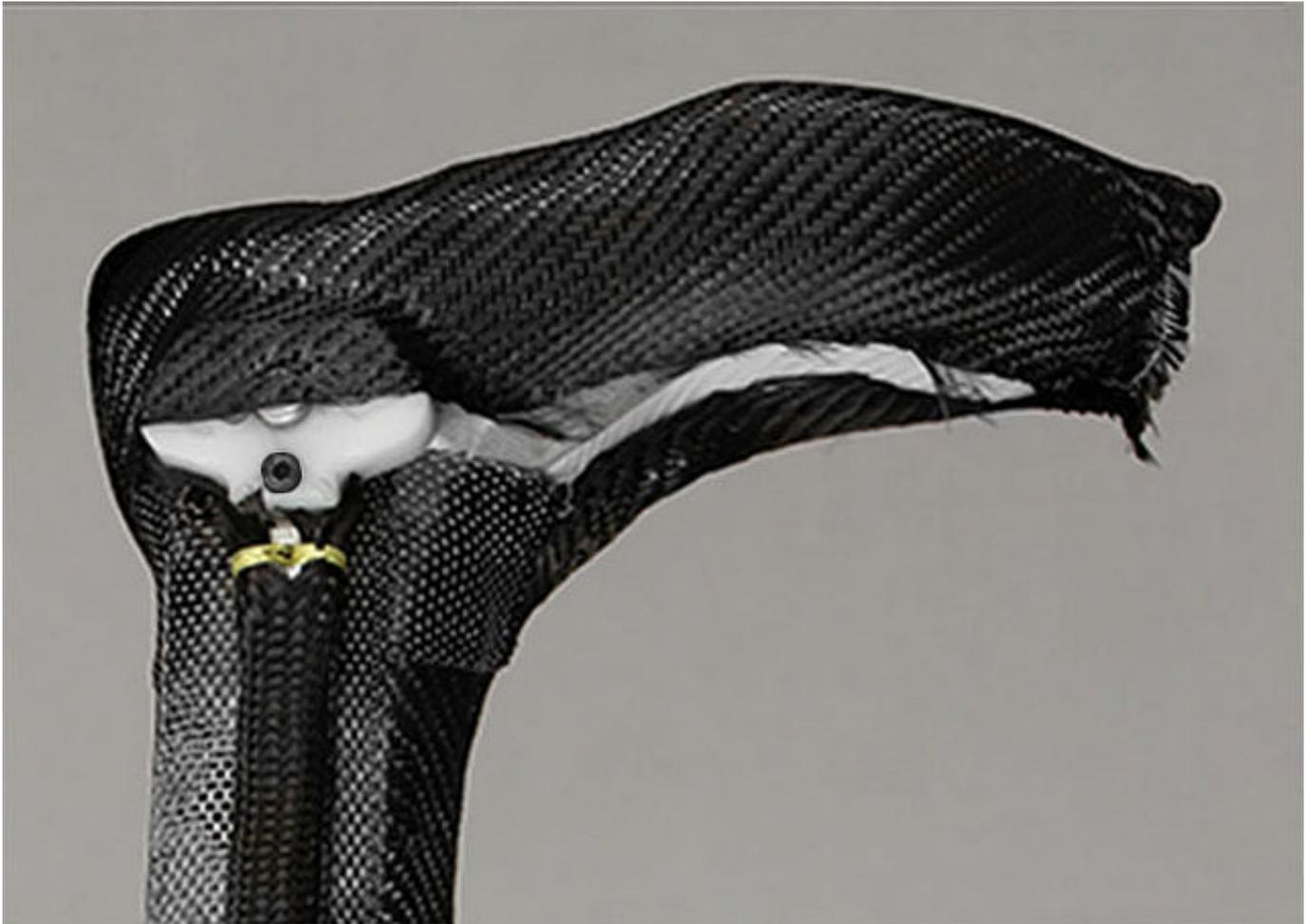
Bringen Sie eine abschließende Lage Carbonfasergewebe auf dem Fußteil an. Bedecken Sie den Montage-/Gießdummy dabei bis zur Hälfte, damit die Oberfolie später nicht beschädigt wird.
