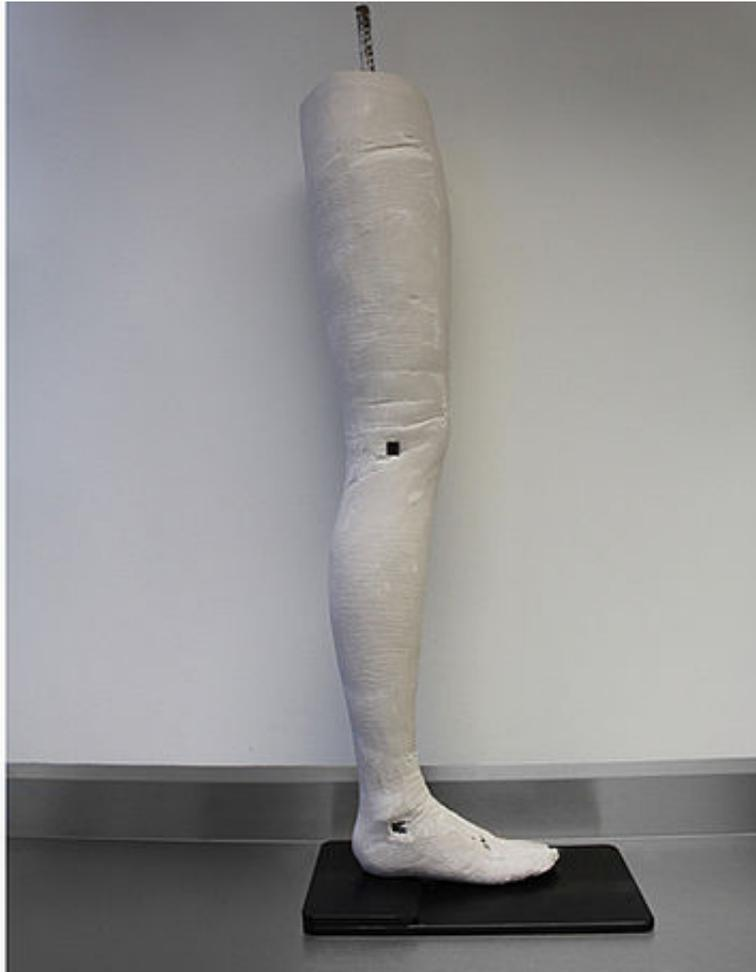
Die durch die Justierachsen entstandenen Vierkantlöcher auf Knie- und Knöchelhöhe befinden sich parallel zueinander, parallel zum Boden und im 90°-Winkel zur Bewegungsrichtung.
