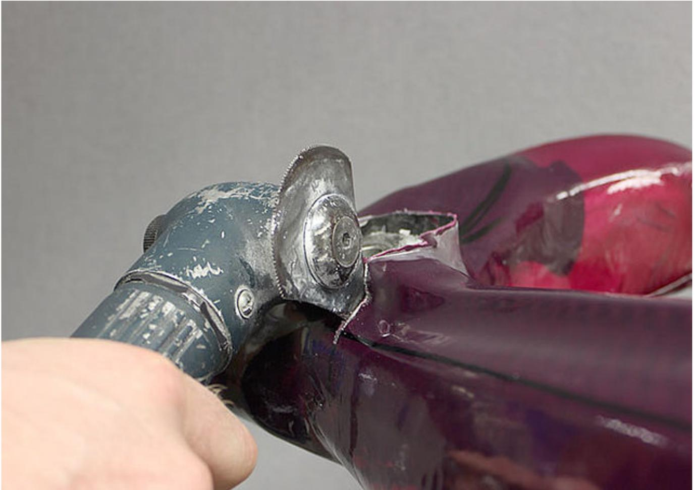
Sägen Sie mit einer oszillierenden Säge entlang der Schnittkanten, um die Orthesenteile vom Modell nehmen zu können. Auf der Abbildung sehen Sie das von uns empfohlene Sägeblatt. Damit können Sie sehr nah am Systemgelenk sägen, ohne es zu beschädigen.
