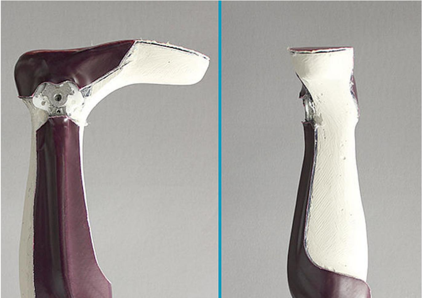
Entfernen Sie die nicht mehr benötigten Laminatteile. Danach können Sie die Orthesenteile vom Modell nehmen.
