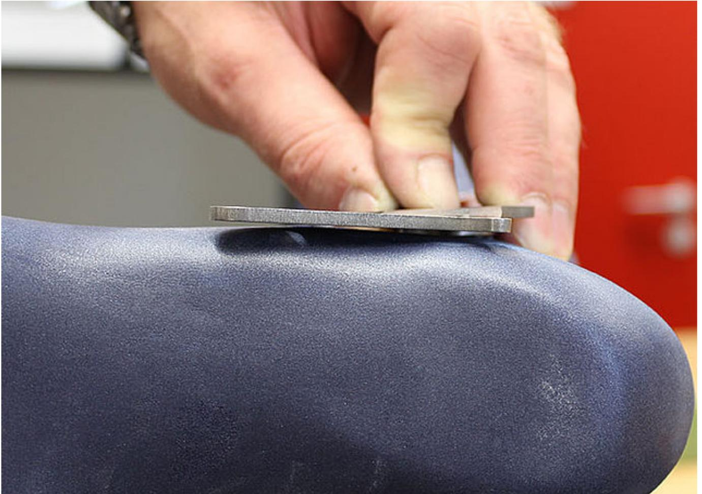
Nehmen Sie den Systemfußbügel aus dem Schraubstock und prüfen Sie den Abstand des Systemfußbügels zum Modell.
