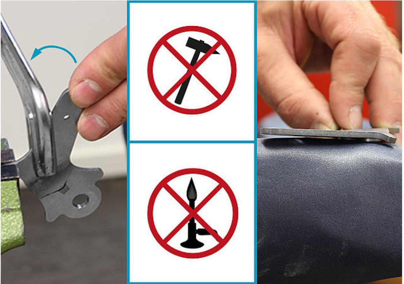
Passen Sie den Systemfußbügel an die Form des Modells an. Schränken Sie den unteren Teil des Systemfußbügels mithilfe eines Schränkeisens. Schränken Sie nur in eine Biegerichtung. Prüfen Sie, ob zwischen Systemfußbügel und Modell ausreichend Platz für die Armierungslagen zur Verfügung steht.
