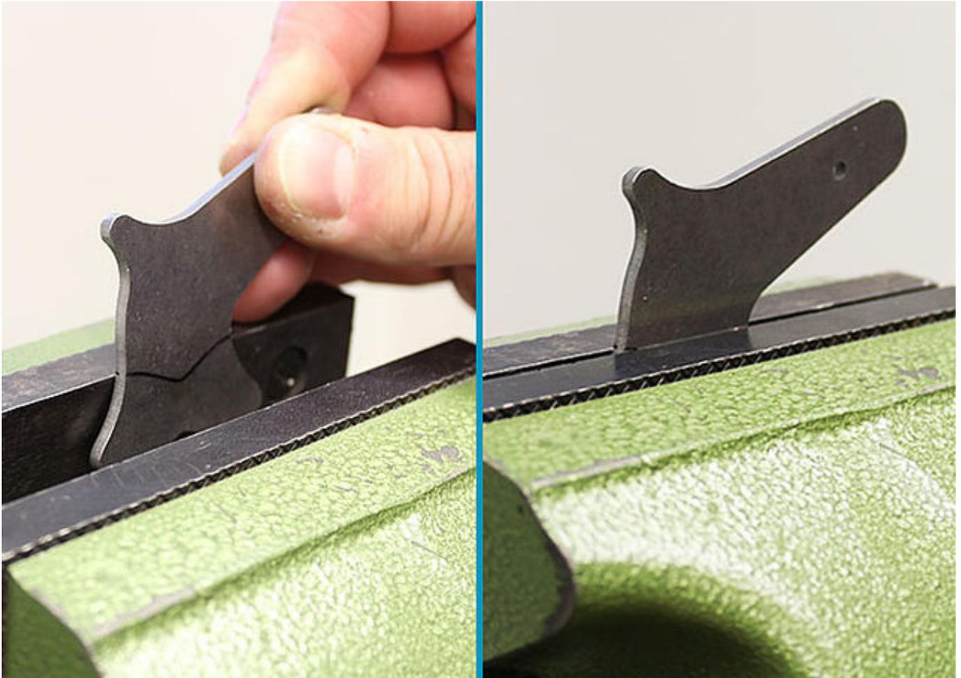
Um den Systemfußbügel zu schränken, spannen Sie ihn in einen Schraubstock mit glatten Backen. Achten Sie auf die Markierung, um Verformungen der späteren Gelenkfläche zu vermeiden und gelenknah schränken zu können.
