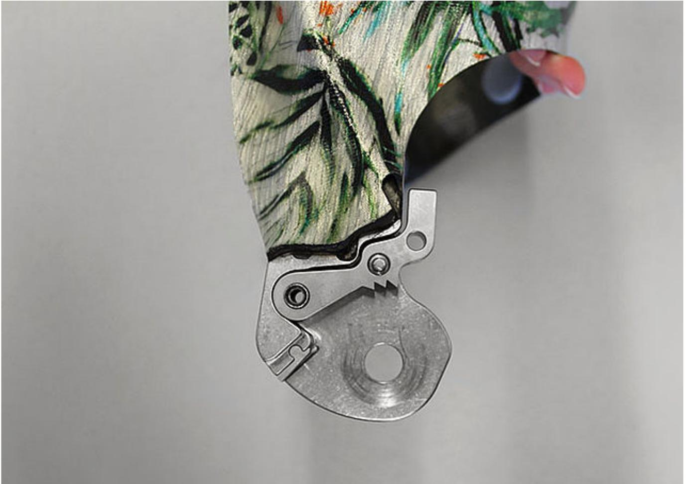
Drücken Sie den Fixierstift gegen die Federkraft in das Systemgelenk, bis er im Gelenkoberteil einrastet. Die Rastensperrklinke ist nun fixiert. Dies erleichtert die weitere Montage des Systemgelenkes.
