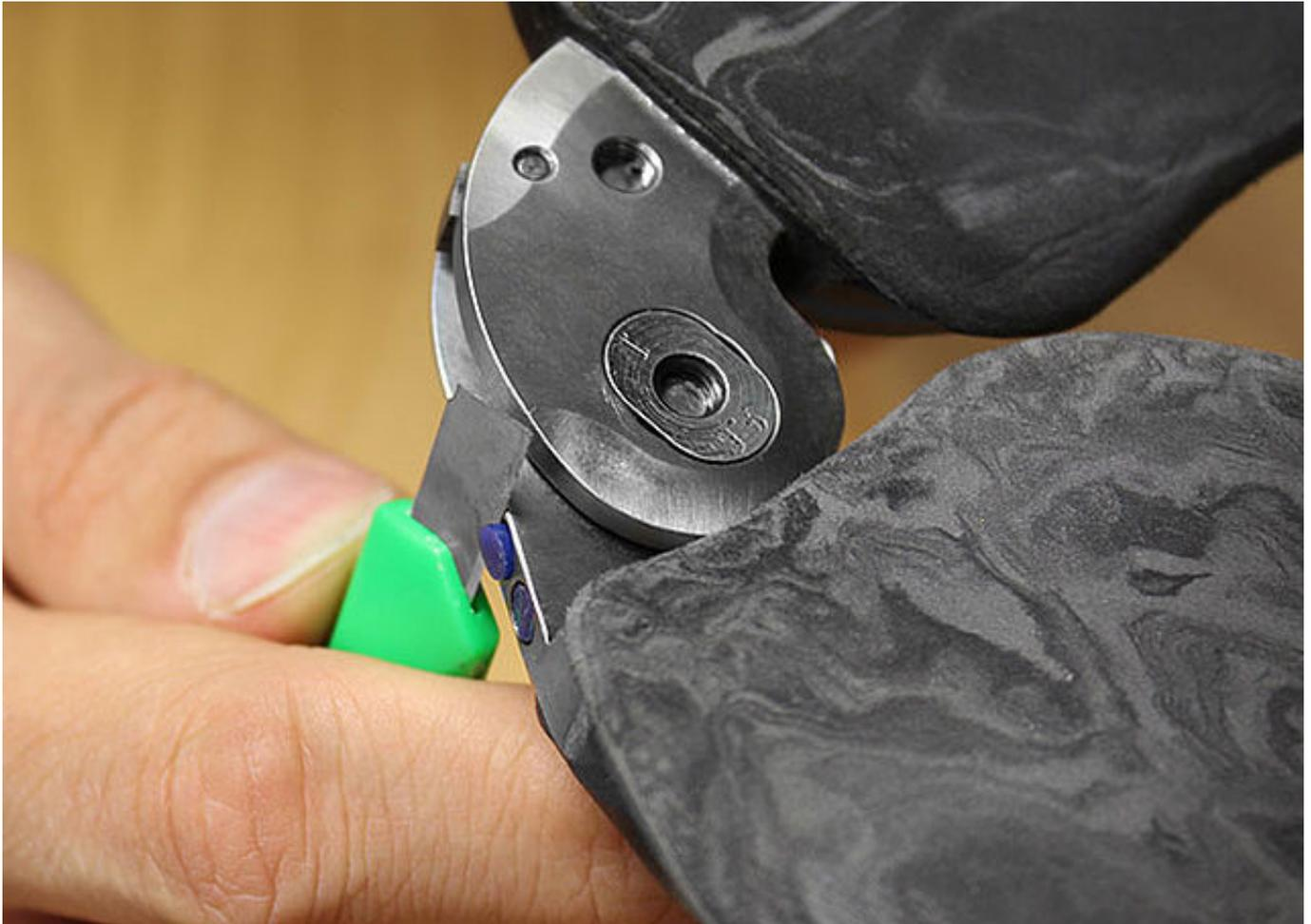
**Falls** Sie ein Mitläufergelenk verwenden, kürzen Sie den Extensionsanschlagsdämpfer mit einem scharfen Messer, sodass die Systemgelenke gleichzeitig den Extensionsanschlag erreichen und die Rastensperrklinke ohne Schwierigkeiten einrastet.
