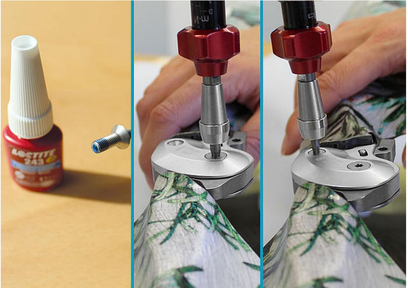
Sichern Sie beide Schrauben mit LOCTITE® 243 mittelfest und dem der Systembreite entsprechenden Drehmoment. Lassen Sie den Kleber aushärten (nach ca. 24 Stunden endfest).
