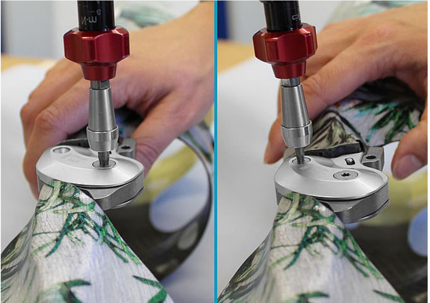
Montieren Sie die Deckplatte. Drehen Sie die erste Senkschraube (Achsschraube) und danach die zweite Senkschraube ein, während Sie weiterhin den Splintbolzen fixieren.
