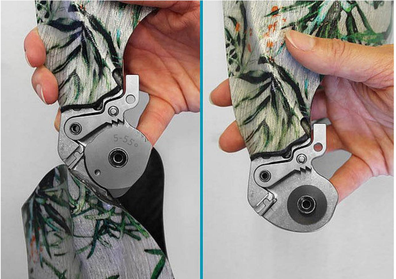
Demontieren Sie das Systemgelenk. Fixieren Sie dafür die Rastensperrklinke (permanente Entsperrfunktion).
