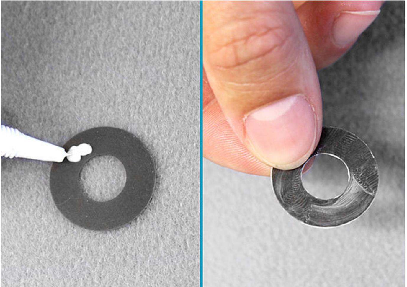
Fetten Sie die zweite Gleitscheibe leicht mit Orthesengelenkfett.
