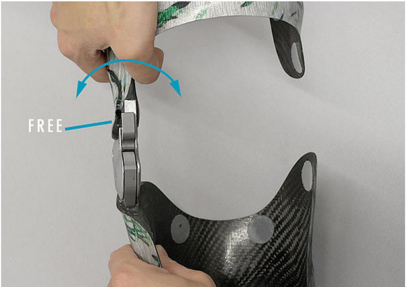
Überprüfen Sie das Systemgelenk auf seitliches Spiel. Fixieren Sie die Unterschenkelschale und versuchen Sie, die Oberschenkelschale in Richtung Varus-Valgus zu bewegen. Setzen Sie bei seitlichem Spiel die nächstdickeren Gleitscheiben ein, wiederholen alle Schritte ab [Schritt 10](#) und prüfen erneut.
