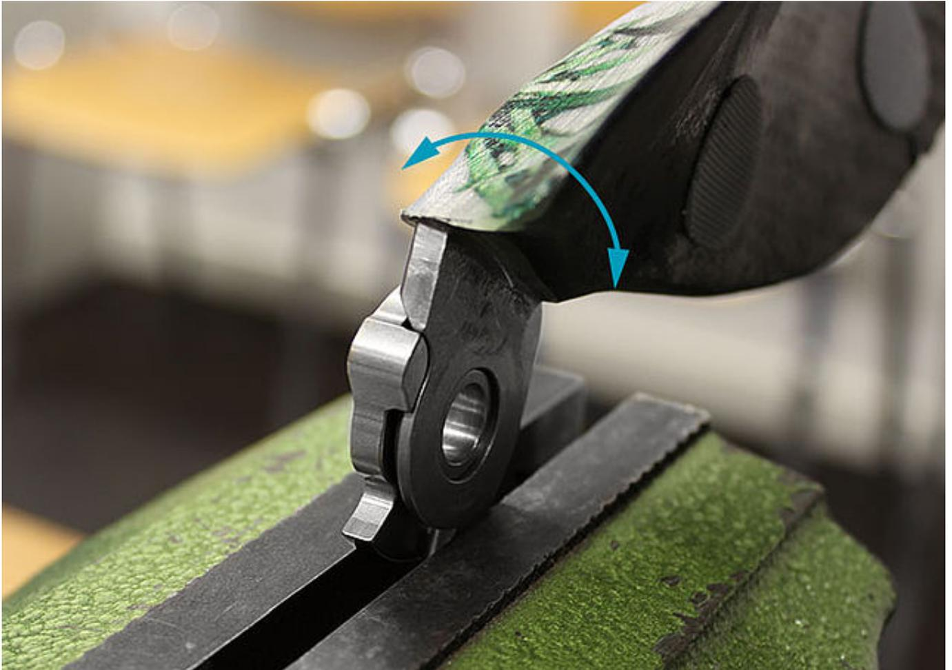
Möchten Sie den Extensionsanschlag austauschen, muss auch die Rastenanschlagsscheibe ausgetauscht werden. Demontieren Sie die Rastenanschlagsscheibe, indem Sie sie in einen Schraubstock spannen und behutsam vom Gelenkunterteil hebeln.
