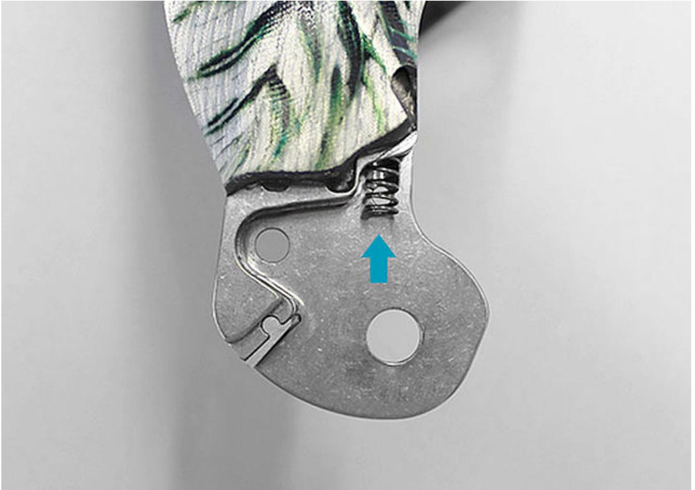
Montieren Sie die Druckfeder, indem Sie sie von unten in den Federkanal des Gelenkoberteiles schieben.
