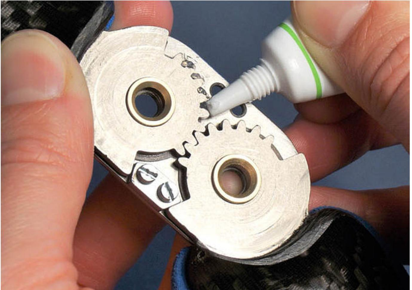
Demontieren Sie die Deckplatte. Fetten Sie die Zahnsegmente der Schienenflügel mit Orthesengelenkfett für Gelenke mit Zahnsegmenten (mit grünem Streifen auf der Tube).
