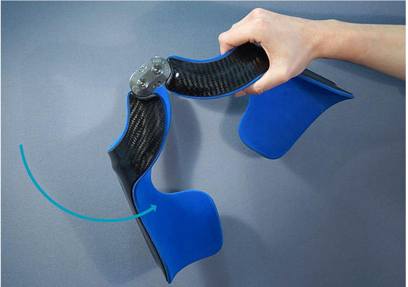
Überprüfen Sie die Leichtgängigkeit. Bringen Sie die Gelenkschiene in Extension. Prüfen Sie die Flexion, indem Sie die Orthese waagrecht halten und dann die Unterschenkelschale loslassen. Die Unterschenkelschale sollte bis zum maximal möglichen Flexionswinkel leichtgängig nach unten fallen. Setzen Sie bei fehlender Leichtgängigkeit die nächsthöheren Bronzebuchsen ein, wiederholen alle Schritte ab [Schritt 7](#) und prüfen erneut.
