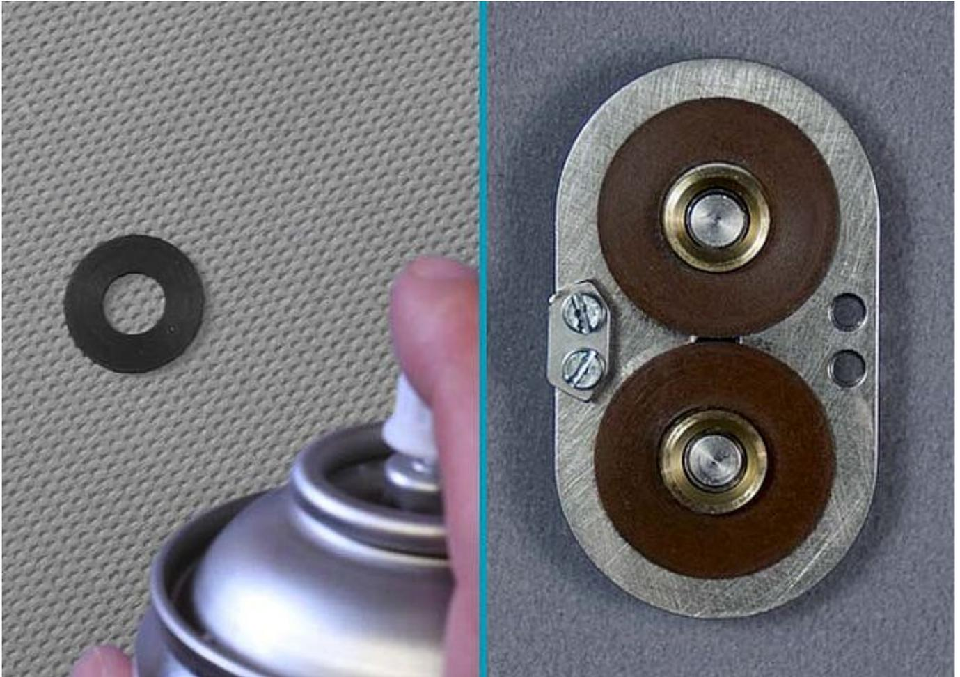
Besprühen Sie zwei Gleitscheiben auf einer Seite mit Sprühkleber und kleben Sie sie auf die Grundplatte. Entfernen Sie die Schrauben und Bronzebuchsen wieder.
