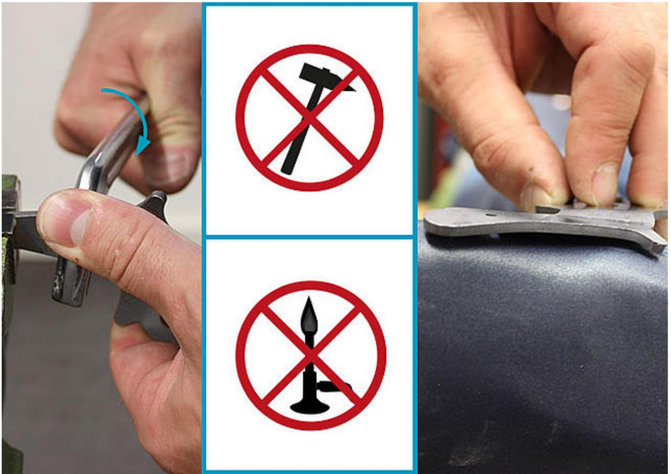
Adaptez l'étrier de pied modulaire à la forme du modèle. Cintrez le pied du l'étrier de pied modulaire à l'aide d'un fer à contourner. Ne cintrez que dans une seule direction de courbure.
