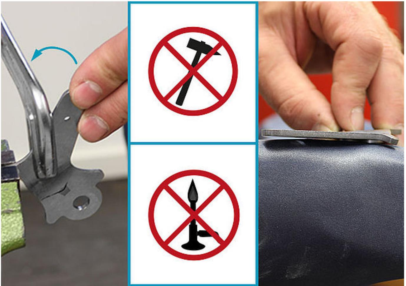
Adaptez l'étrier de pied modulaire à la forme du modèle. Cintrez la partie inférieure de l'étrier de pied modulaire à l'aide d'un fer à contourner. Ne cintrez que dans une seule direction de courbure.
