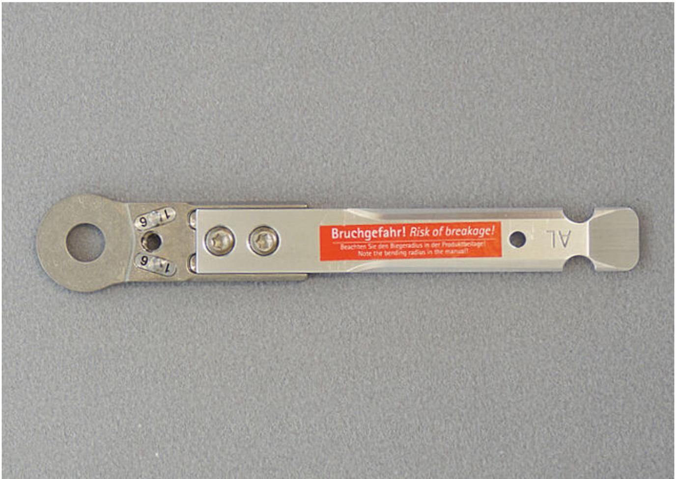
Avant de commencer le cintrage, fixez l'ancre modulaire avec la vis éloignée de l'articulation dans la partie supérieure de l'articulation.
